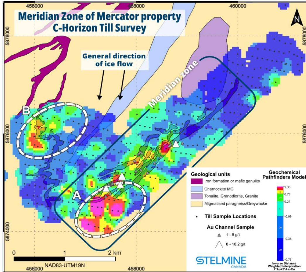
Figure 1. **L'anomalie A** est située directement en descente de l'écoulement glaciaire à partir du cœur de la minéralisation de la Zone Meridian, alors que **l'anomalie B**, récemment identifiée recouvre des affleurements de formation de fer.
