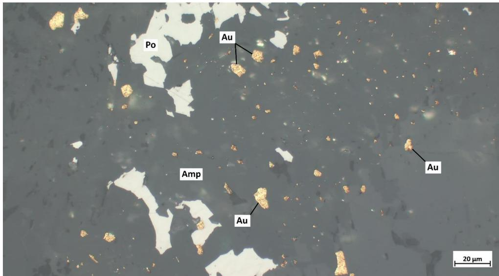
**Figure 2.** Plusieurs grains d'or natif (Au) inclus dans un agrégat secondaire d'amphibole (Amp) et de pyrrhotite (Po).
