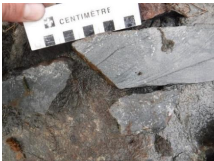
Figure 10 : Amphibolite avec 2-6% sulfures (arsénopyrite, pyrrhotite et pyrite) échantillonné en rainure de 1 m de long. (2.2 g/t Au) / Amphibolite containing 2-6% sulfides (arsenopyrite, pyrrhotite and pyrite) in a 1 m-long channel sample.
