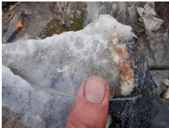
Figure 8 : Veine de quartz et feldspaths avec traces arsénopyrite. / Quartz feldspar vein with traces of arsenopyrite.
