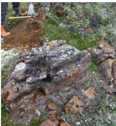
Figure 5 : Bloc de meta-sédiments migmatisés avec 5-10% pyrrhotite (échantillon choisi : 7.4 g/t Au) : Migmatized metasedimentary boulder containing 5-10% pyrrhotite (grab sample : 7.4 g/t Au)
